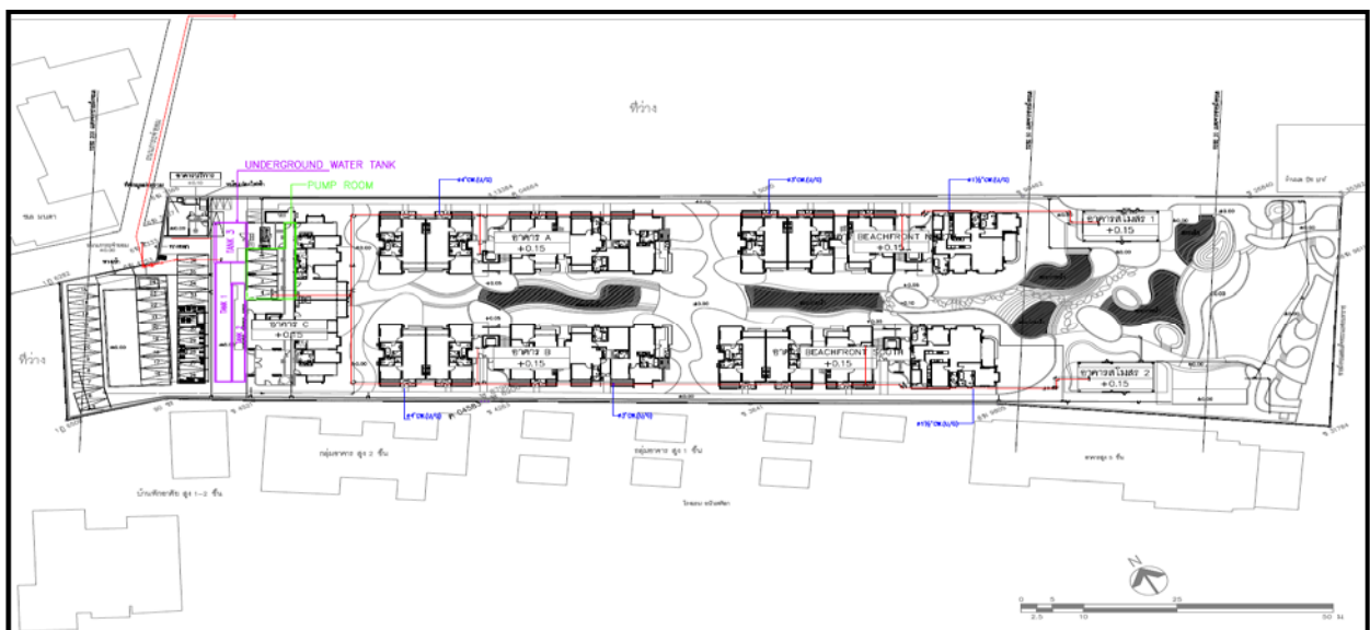
รูปที่ 1.9.1-1 ผังระบบจ่ายน้ำประปา และตำแหน่งถังเก็บน้ำใต้ดิน และห้องเครื่องปั๊ม
